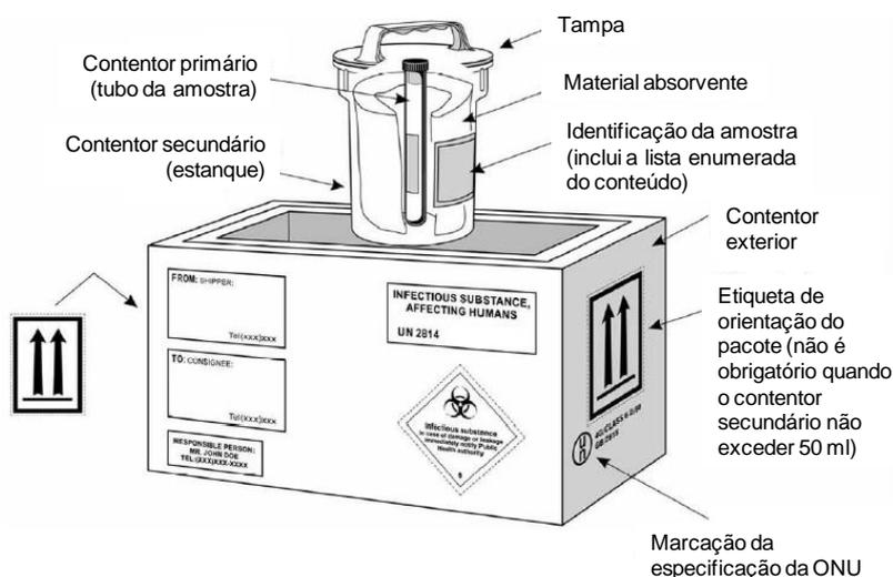
**Figura 1:** Exemplo de sistema de embalagem tripla para o acondicionamento e rotulagem dos produtos biológicos para o diagnóstico de febres hemorrágicas virais (categoria A). O acondicionamento deve cumprir os seguintes procedimentos<sup>4</sup>:
